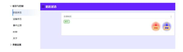
防区状态:显示当前所有防区信息。设备状态:显示所有设备当前信息。事件记录:显示所有记录信息。时钟:设置系统时钟信息,点设置主机时钟可使报警主机时间与电脑同步。关于:显示版本信息、产品信息、网络信息。
