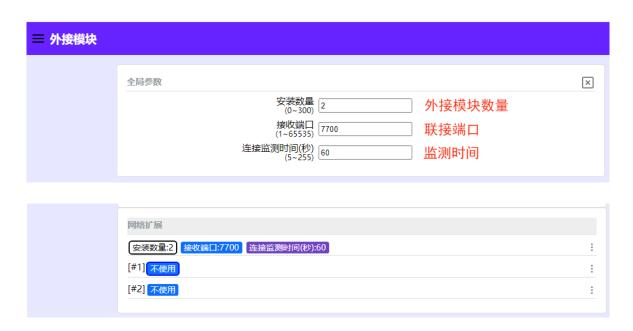
2: 启用总线设备; 点【#1】右边三点符号弹出界面配置模块输入类型(连续相同类型模块可以 批量设置);
