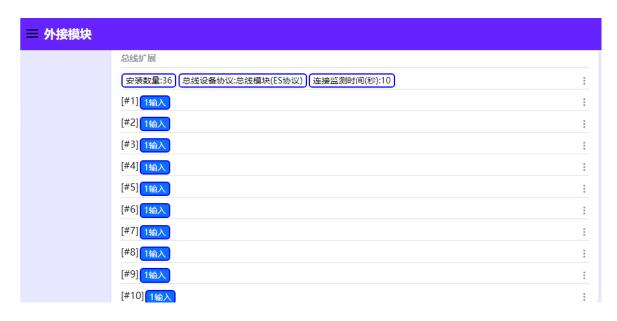
2: 启用网络设备; 点【#1】右边三点符号弹出界面配置模块输入类型(连续相同类型模块可以 批量设置);
