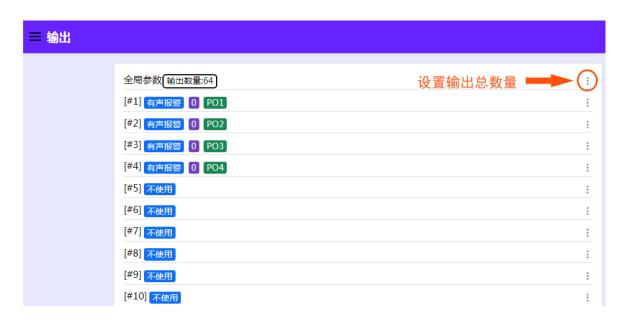
育 首先在全局参数设置输出总数,才可以配置下面每个点输出;板载输出在 1#至 2#。
